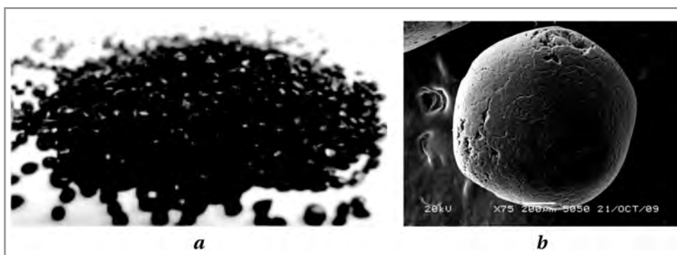
Рис. 1. Углеродный сорбент: вид препарата (а) и гранула сорбента под сканирующим электронным микроскопом (b)
